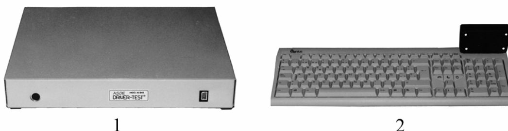
Fig. 4. 1) Procesador. 2) Teclado, con la unidad de verificación y seguimiento de las respuestas incorporada en el extremo superior derecho del teclado.
